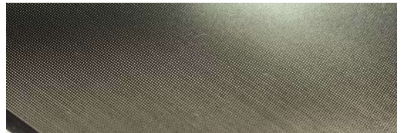
Mikrobohrungen für eine Filterapplikation
