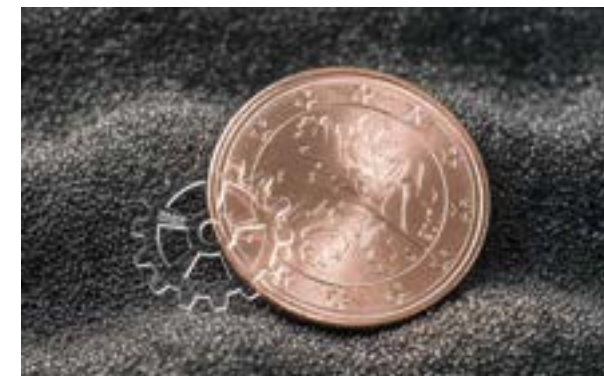
Zuschnitt und Strukturierung eines Glaszahnrad
