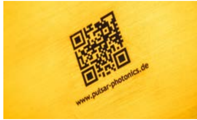
Widerstandsfähige Lasermarkierung in Stahloberfläche
