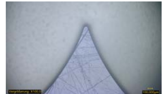
Formfreier Zuschnitt einer Keramik
