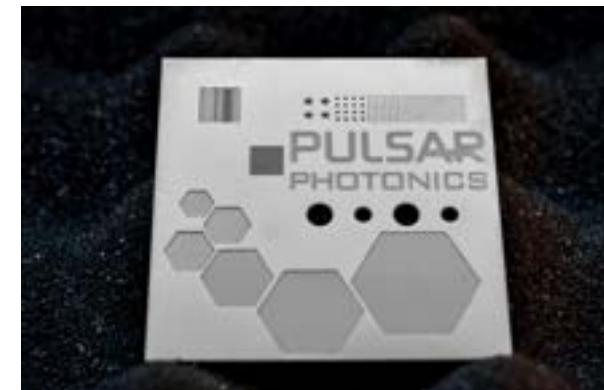
Strukturierungsbeispiele in einer Al 2 O 3 -Keramik
