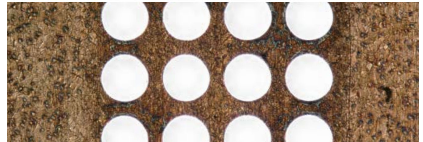
Matrix von Präzisionsbohrungen in Messing
