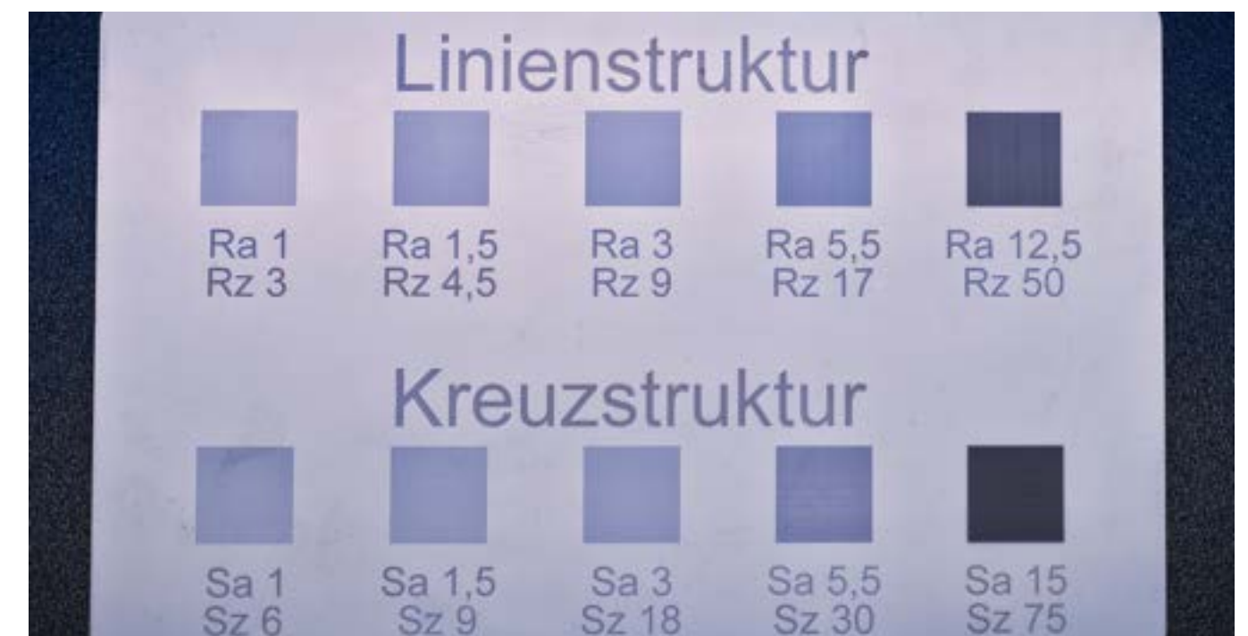
Erzeugung von definierten Ra-/Sa-Werten in Keramik
