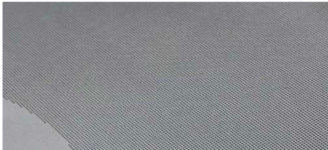
QCW-Bohrungen eines Siebes (nach Reinigungsschritt)
