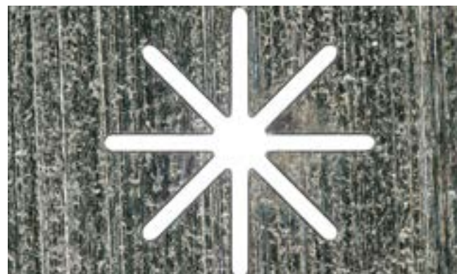
Sternförmige Mikroschnitte in Edelstahl
