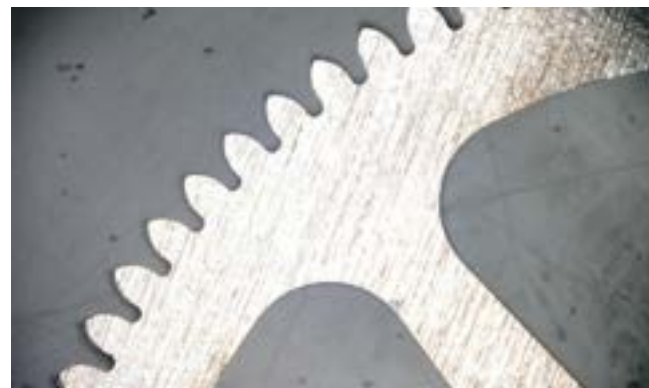
Ausschnitt eines Mikro-Zahnrades
