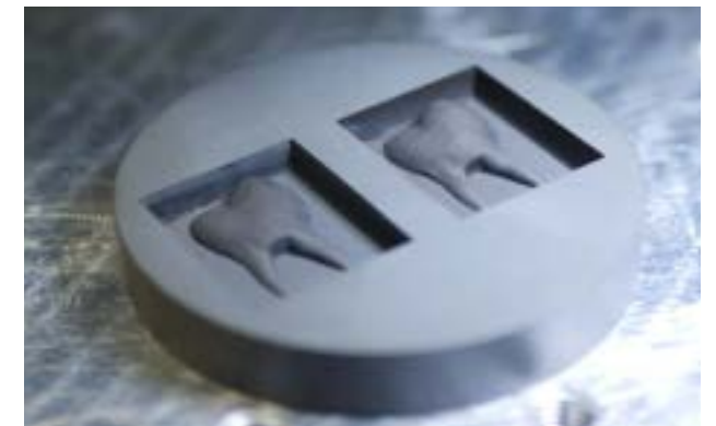
2,5D Strukturierung: Wurzel eines Zahnimplantates aus einer Hochleistungskeramik
