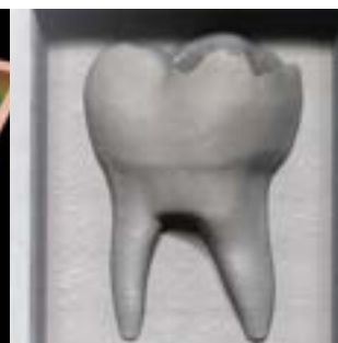
2,5D Struktur eines keramischen Zahnimplantates
