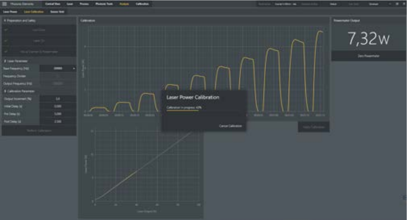
Laufende Kalibrierung der Laserleistung: Für einen bestimmten Parametersatz wird eine Kalibrierkurve erstellt und in der Datenbank gespeichert
