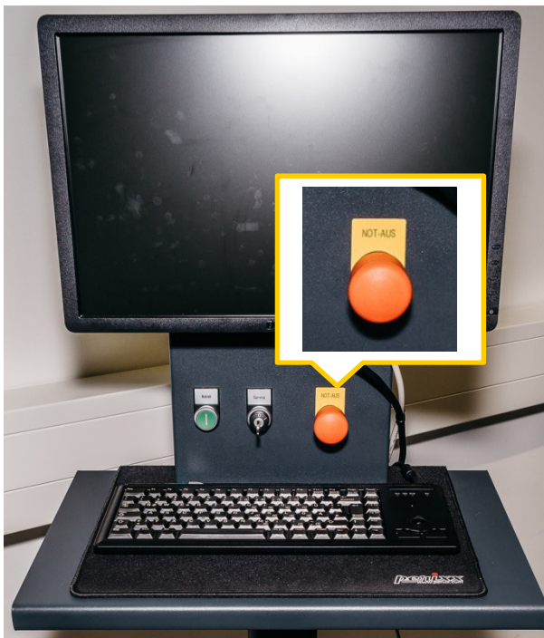
Abbildung 1-1: Not-Aus Taster am Bedienplatz
