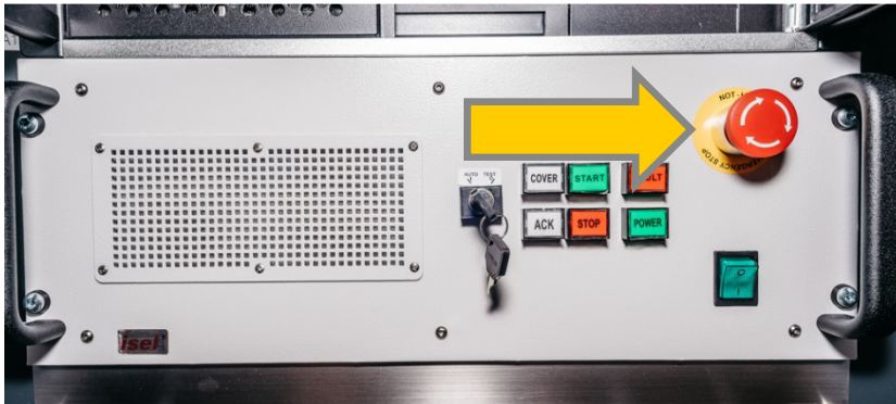
Abbildung 1-2: Not-Aus-Taster auf Frontseite des Steuergeräts
